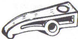
Fig. 22 : Un type de culbuteur utilisé sur les moteurs à soupapes en tête.
