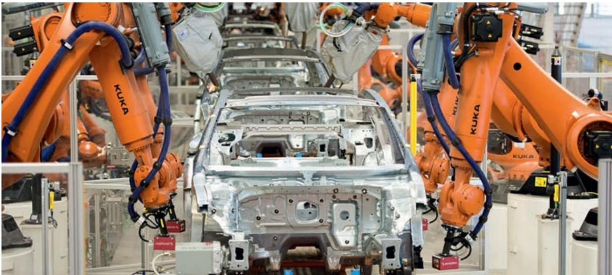
Schweißroboter in der Produktion des Passat im **Volkswagenwerk** in Emden
