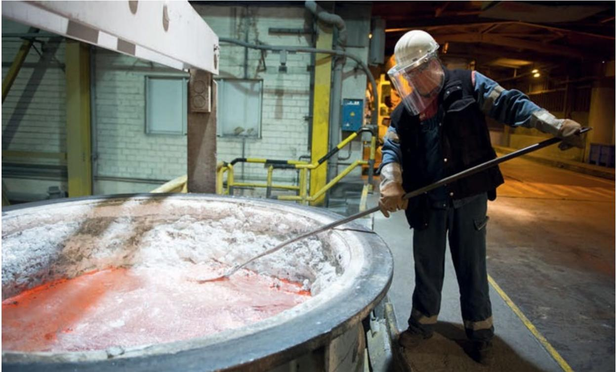
Auch heute noch wird das **Haber-Bosch-Verfahren** bei der Herstellung von Ammoniak angewandt. Das Foto, auf dem ein Arbeiter in Essen flüssiges Aluminium in einem Kessel reinigt, stammt aus dem Jahr 2014.
