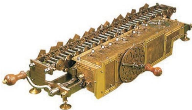
**Leibniz' Rechenmaschine** war eine sogenannte Staffelwalzenmaschine. Sie wurde nie in Serie gefertigt.
