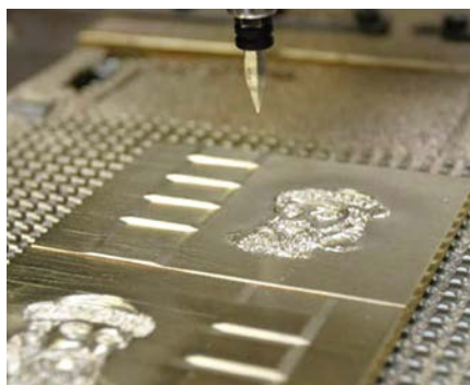
Auch die Werkzeuge, mit denen Wasserzeichenmotive auf die Geldscheine gedruckt werden, stellt G+D her.
