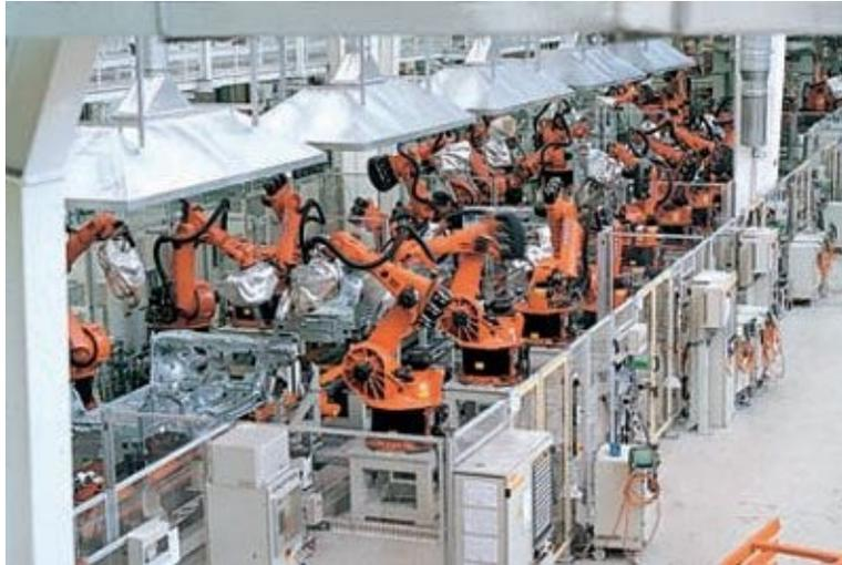
**Rationalisierung** Einsparung menschlicher Arbeitskraft durch den Einsatz von Schweißrobotern; nur noch wenige Menschen überwachen diese Halle im Wolfburger Volkswagenwerk, in der Rohkarosserien hergestellt werden.
