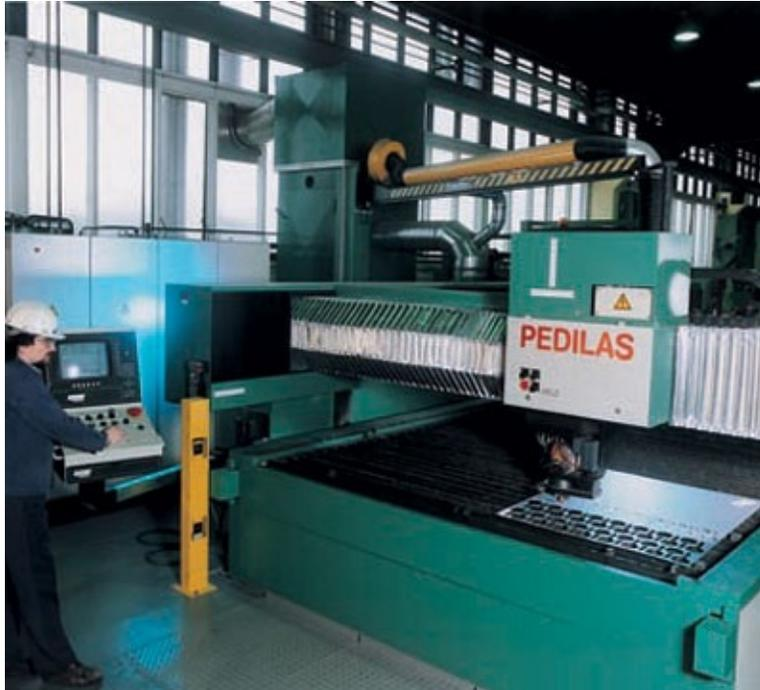
**Laser** Anwendung in der Industrie; diese Flachbett-Laserschneideanlage kann auf einer Fläche von 2,5 · 4m bis zu 15mm dicken Edelstahl verarbeiten
