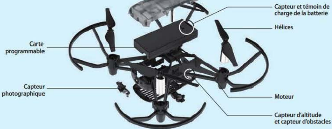
Les différents composants d'un drone programmable
